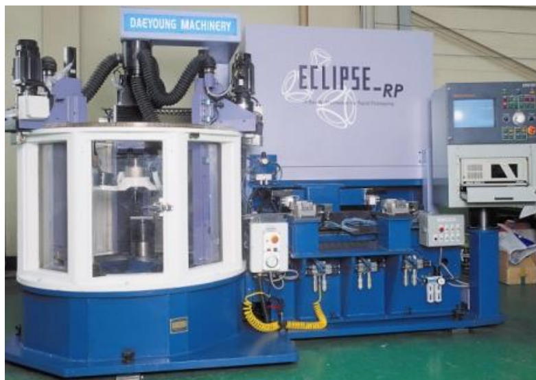
Рисунок 30 – Пятикоординатный станок «Eclipse-RP» производства «Daeyoung Machinery»
