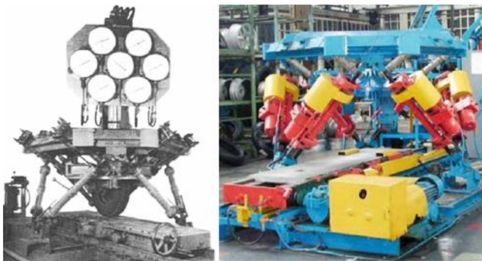
Рисунок 5 – Первый октаэдральный гексапод конструкции Э. Гью
