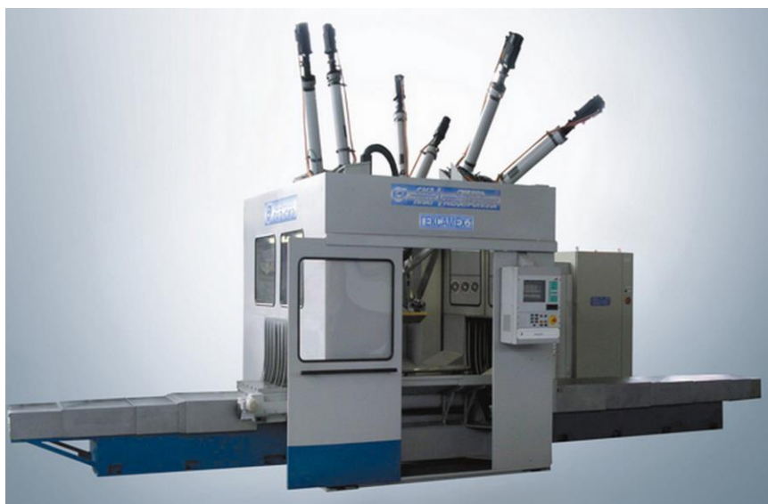
Рисунок 16 – Обрабатывающий центр с параллельной структурой «Гексамех-1»
