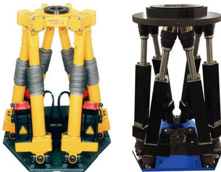
Рисунок 27 – Роботы-гексаподы «F-200iB» производства «Fanuc Corporation» (слева) и «P2100» производства «Mikrolar, Inc» (справа)
