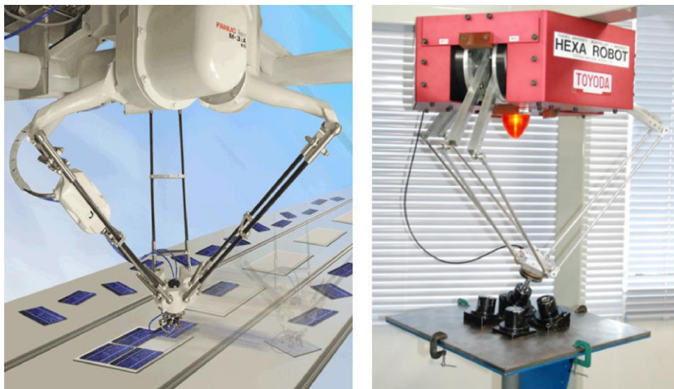
Рисунок 22 – Высокоскоростные роботы «Delta» (слева) и «Неха» (справа)
