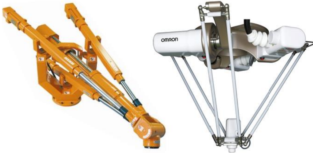
Рисунок 8 – Конструкции роботов «Tricept» и «Delta»
