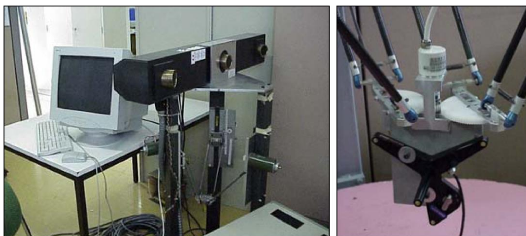
Рисунок 79 – Калибровка четырехкоординатного параллельного робота с использованием 3D камеры
