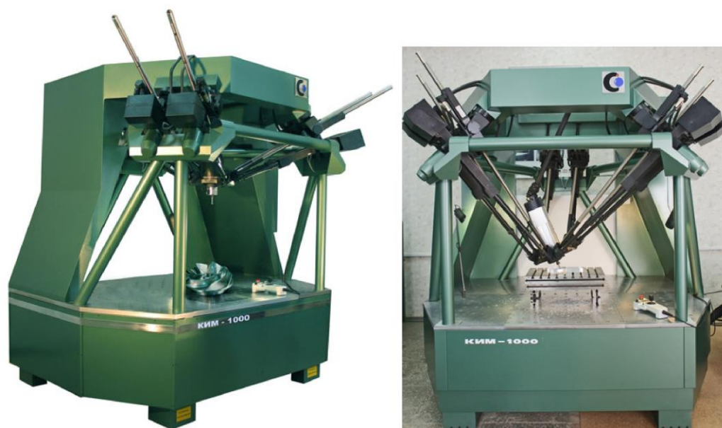
Рисунок 25 – Координатно-измерительная машина «КИМ-1000» (ООО «ЛАПИК») с измерительной (слева) и шпиндельной (справа) головкой
