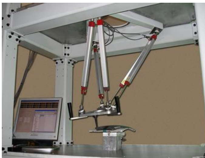
Рисунок 26 – Координатно-измерительная машина «С2000» производства «Mikrolar, Inc»
