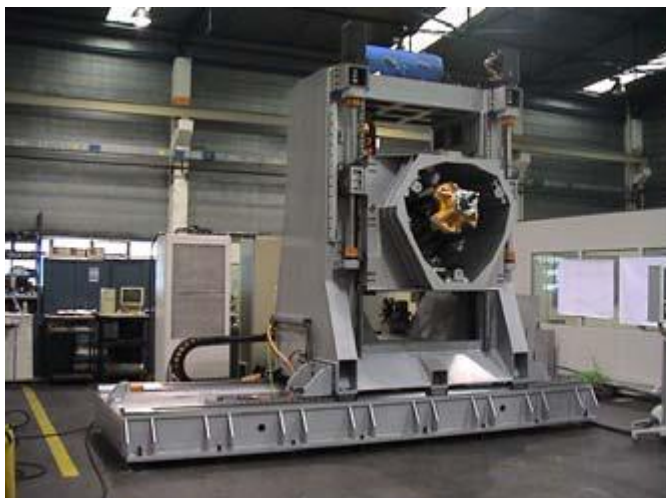
Рисунок 31 – Станок «Space 5H» с параллельным модулем «Hermes»
