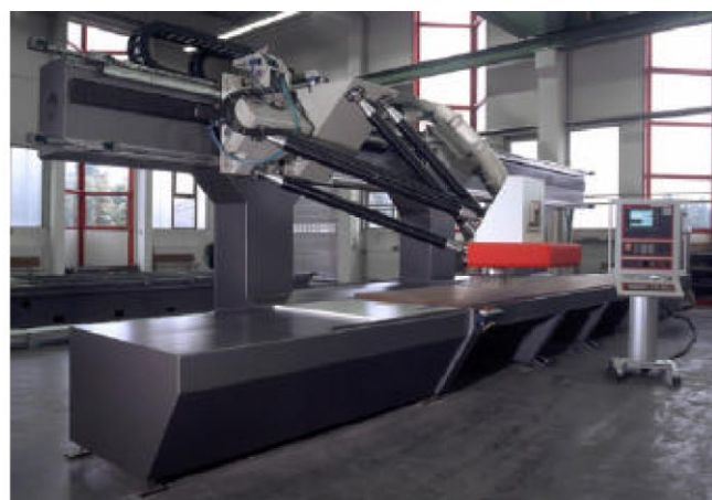
Рисунок 17 – Обрабатывающий модуль «СМW 380» (слева) и станок-гексапод «Pegasus» (справа)
