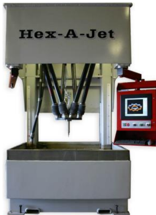
Рисунок 28 – Установка «Hex-A-Jet» на базе гексапода «P3000»
