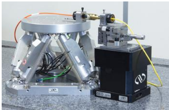
Рисунок 21 – Укладка волокон оптического кабеля при помощи гексапода «Newport»
