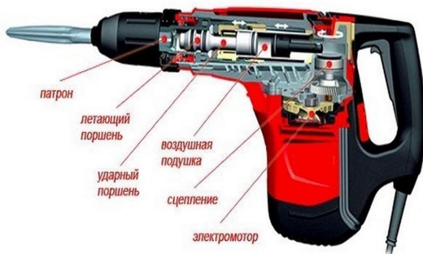
Рисунок 10–Устройство электрического перфоратора
