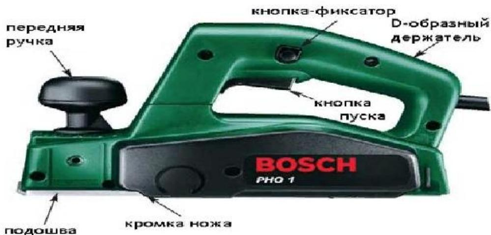
Рисунок 3 – Электрорубанок
