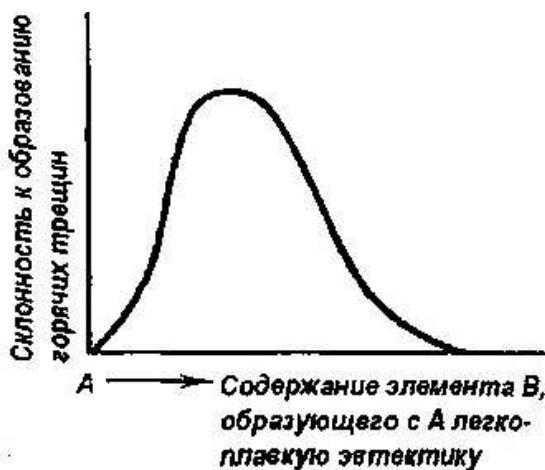
Рисунок 1.5 – Влияния элемента на изменение его склонности к образованию горячих трещин
