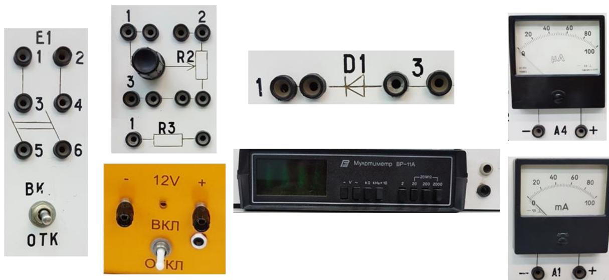
Рисунок 1.4 – Элементы и измерительные приборы, используемые в лабораторной работе
