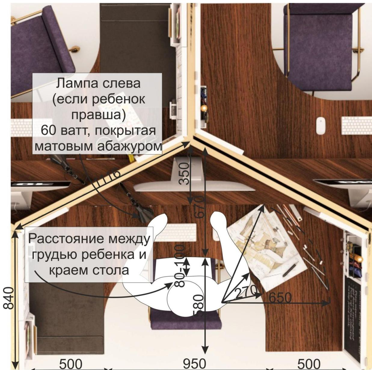
Рисунок 9 - Соматографический анализ рабочего места в кабинете программирования (вид сверху)
