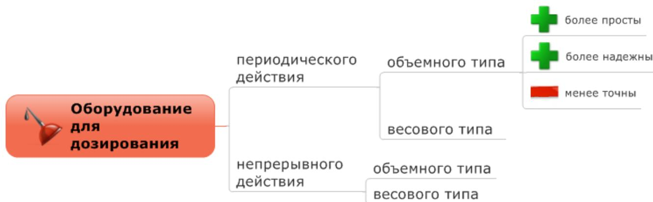
Рисунок 2.2 – Классификация оборудования для дозирования
