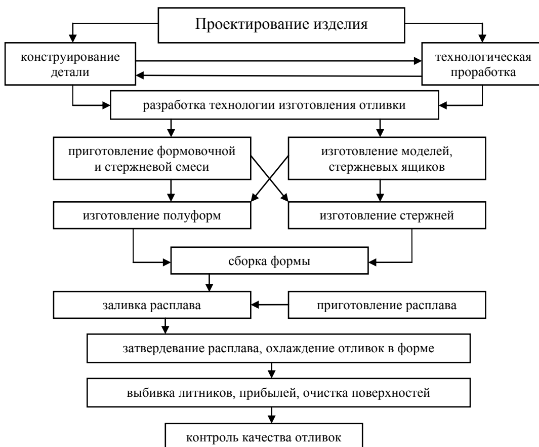
Рисунок 1.1 – Схема технологического процесса изготовления отливки
