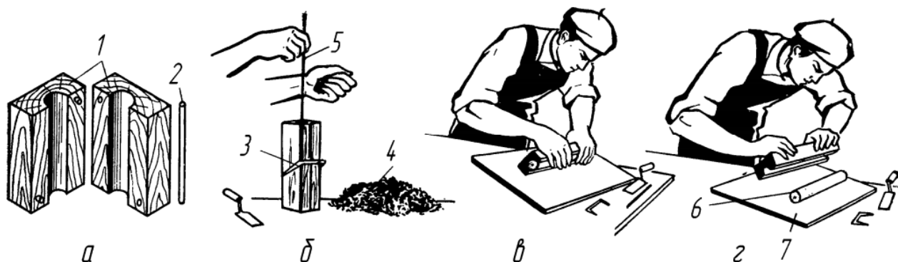
а – подготовка стержневого ящика; б – засыпка ящика смесью; в – разработка стержневого ящика; г – извлечение стержня
