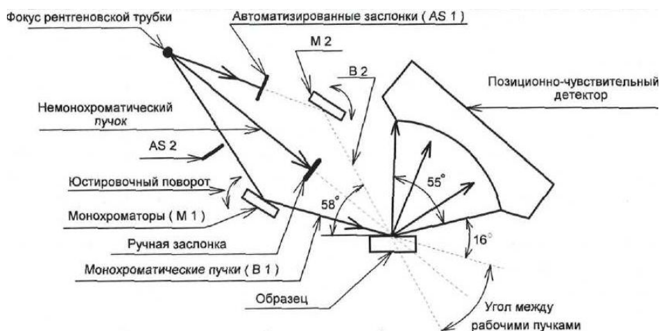
Рисунок 1 – Рентгенооптическая схема дифрактометра МД-10 ЭФА
