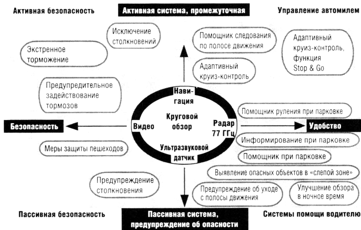
Рисунок 4.1 – Системы повышения безопасности, имеющие функции безопасности и обеспечения управления и основанные на датчиках кругового обзора
