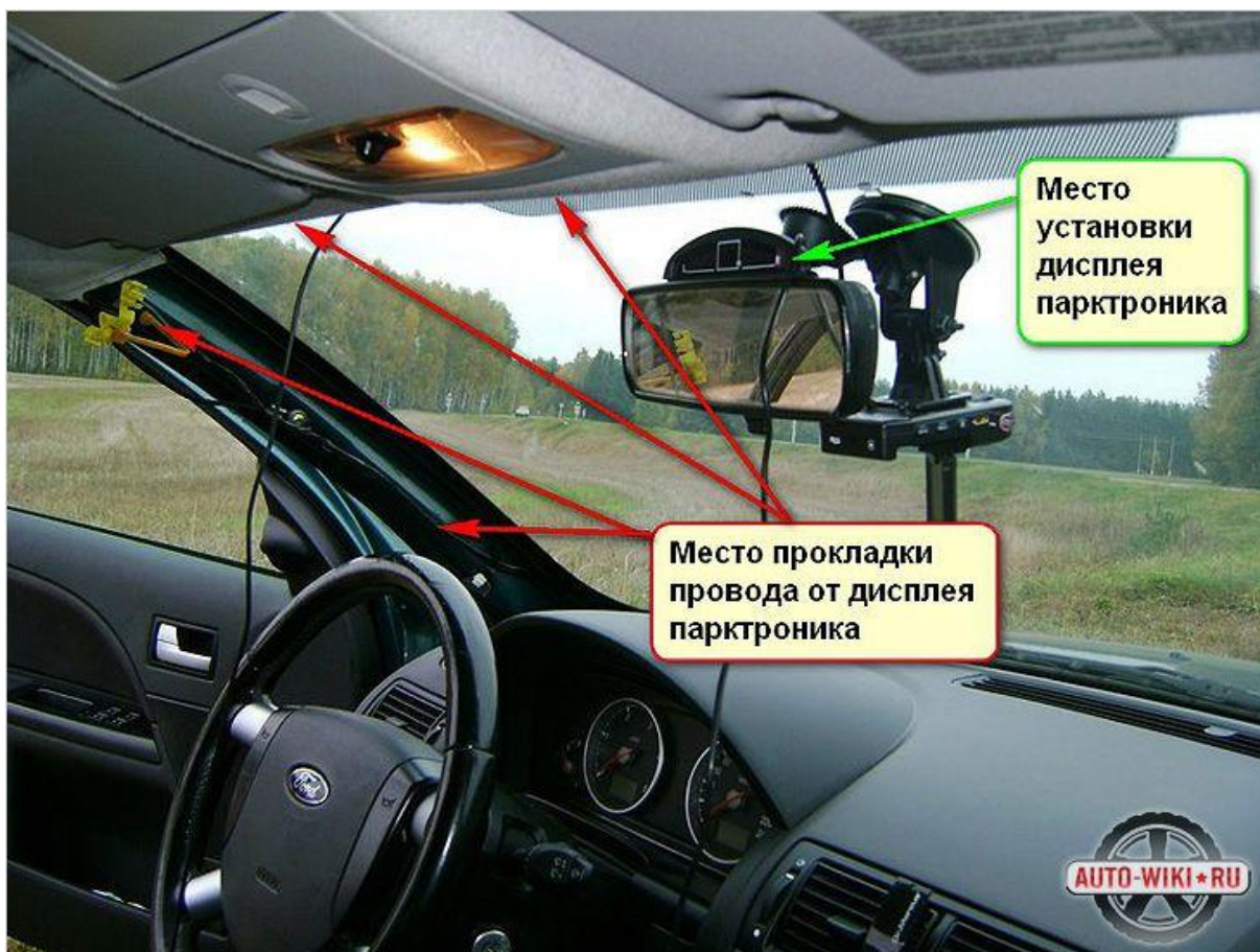
Рисунок 5.4 – Установка информационного дисплея
