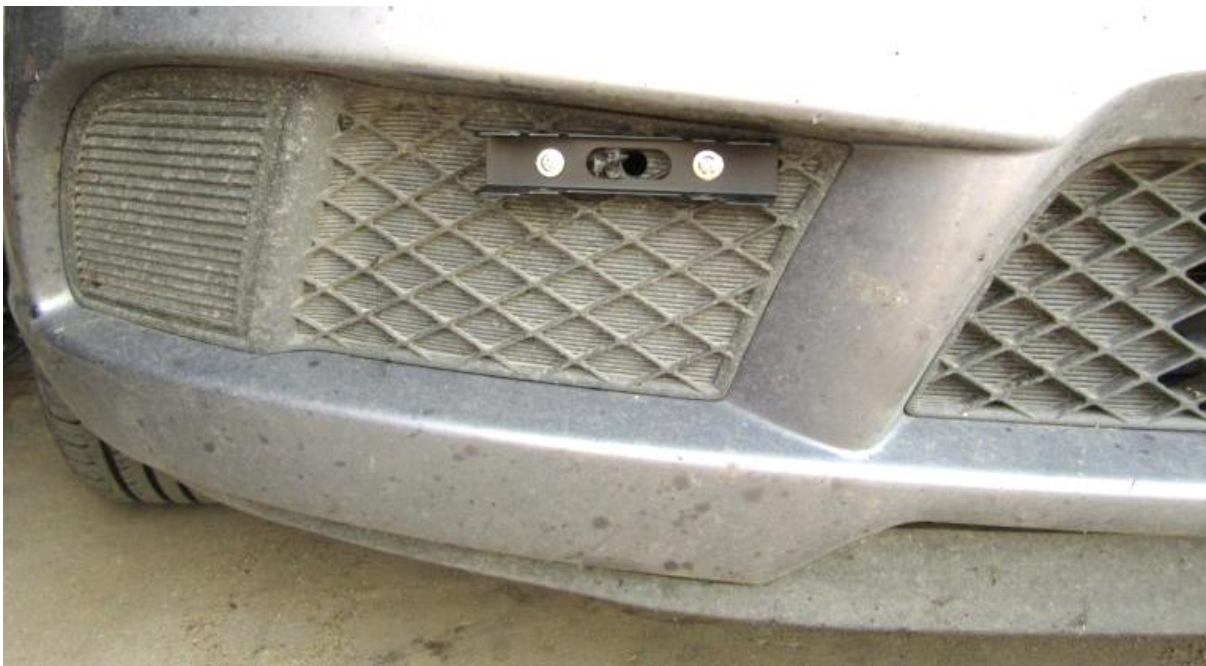
Рисунок 50 – Крепёжные скобы закреплённые на саморезы
