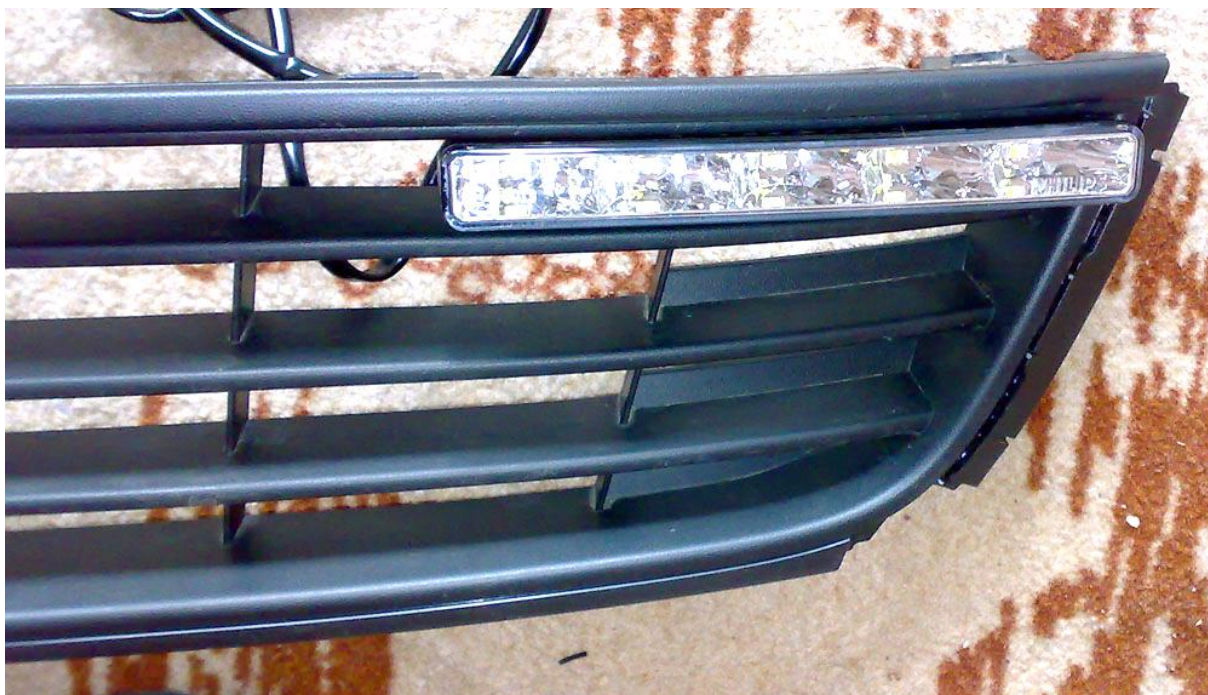
Рисунок 49 – Установки дневных ходовых огней в радиаторную решетку
