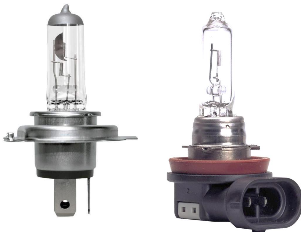
Рисунок 26 – Галогенные лампы (слева двухнитевая H4, справа – противотуманная HB3)
