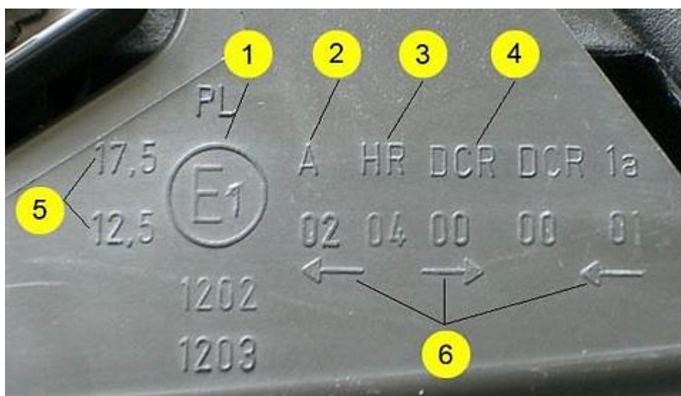
Рисунок 35 – Маркировка автомобильной фары головного света
