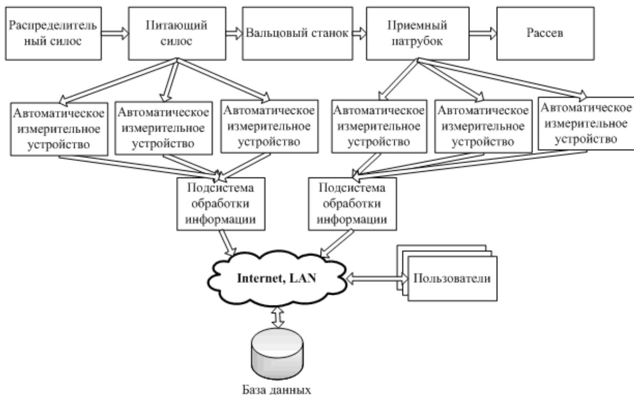
Рисунок 1.13 - Функциональная схема измерительного оборудования
