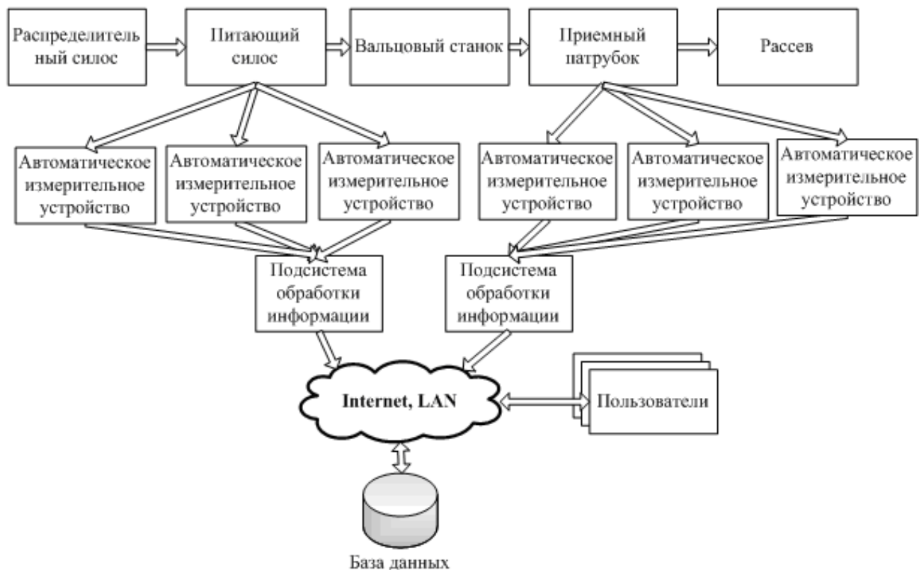
Рисунок 1.7 - Функциональная схема измерительного оборудования
