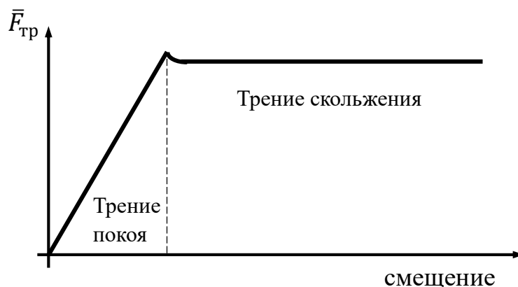
Рисунок 3.3 – Зависимость силы трения от скорости
