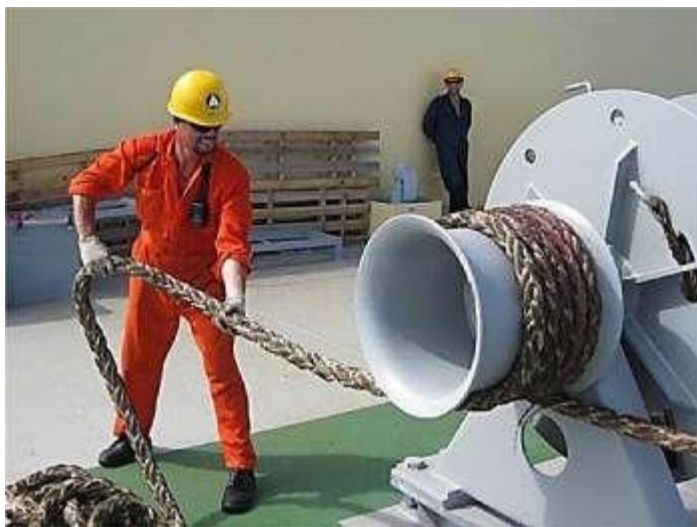
Рисунок 6.3 – Процесс подтягивания судна к причалу или к другому судну с последующим креплением его в неподвижном состоянии называется швартовкой судна
