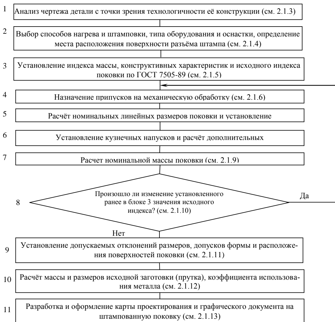
Рисунок 2.8 – Алгоритм проектирования штампованной поковки
