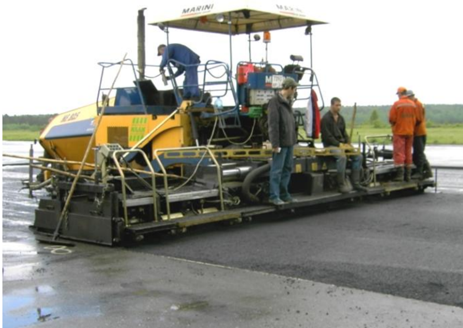
Рис. 3.2. Широкозахватный асфальтоукладчик MARINI MF-805 во время экспериментальных исследований
