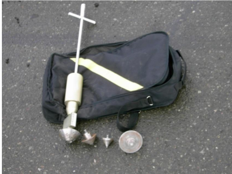
Рис. 3.5. Динамический плотномер ДПУ-1 с опытными наконечниками
