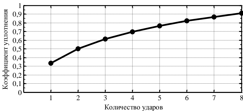
Рис. 2.56. Изменение коэффициента уплотнения
