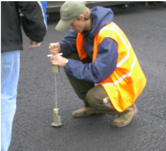
Рис. 3.6. Испытание плотномера ДПУ-1
