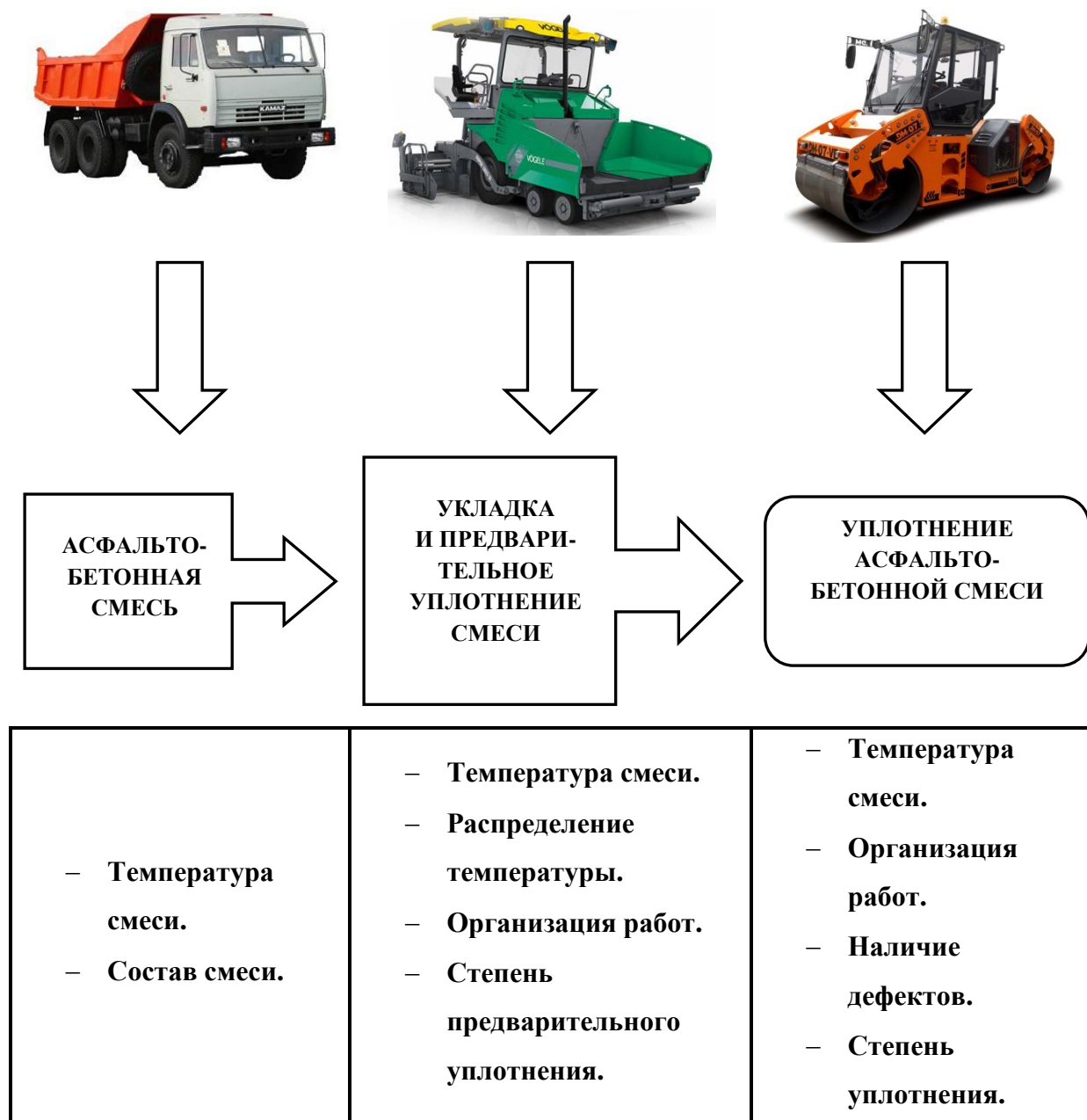
Рис. 3.1. Технологический процесс укладки и уплотнения асфальтобетонной смеси
