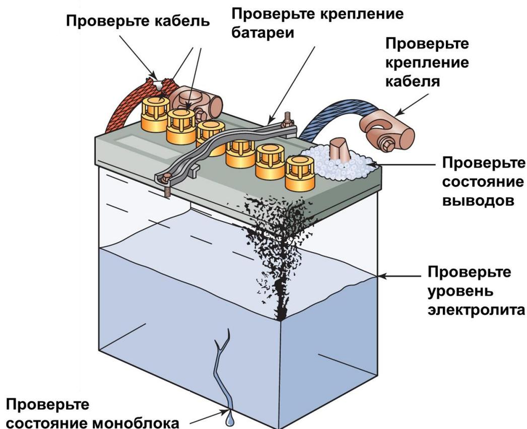
Рисунок 5.1 – Внешний осмотр аккумуляторной батареи
