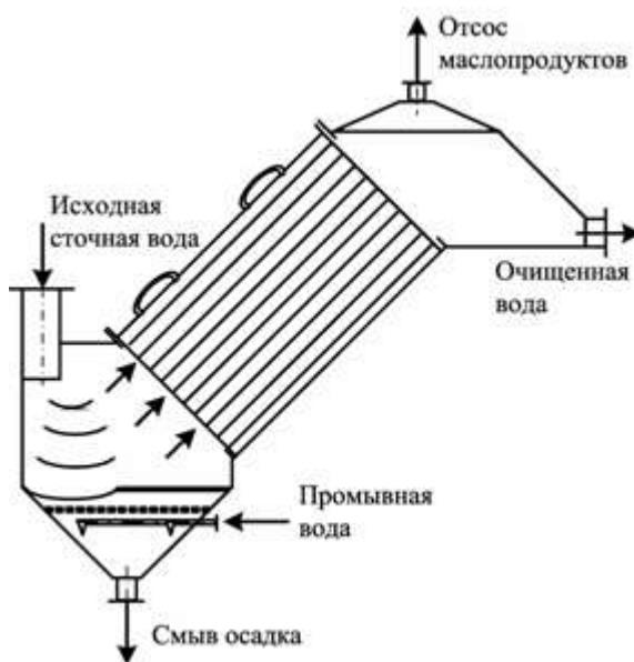
Рис. 10. Схема многоярусного отстойника
