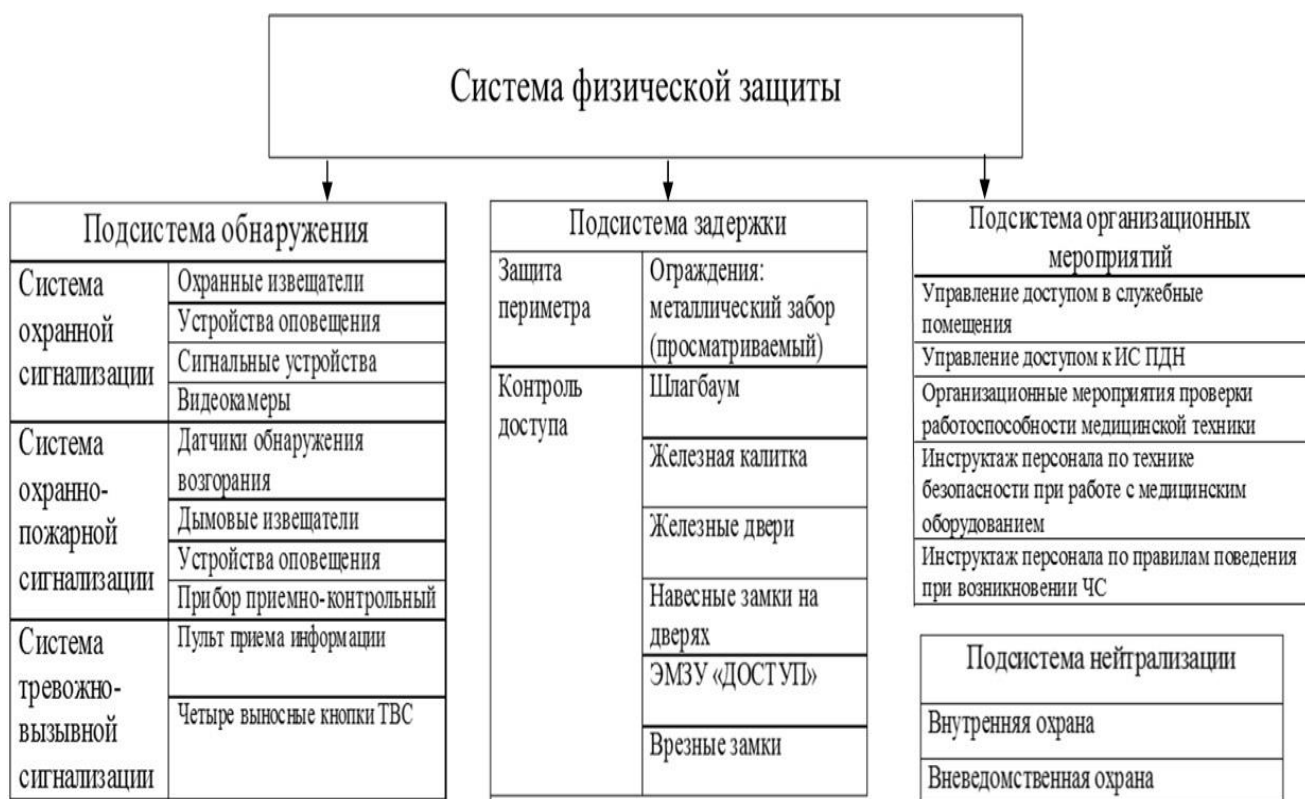
Рисунок 7.7 – Пример структурной схемы физической защиты объекта
