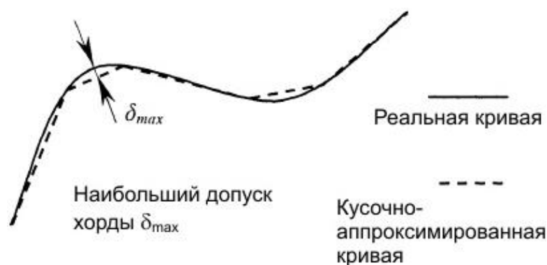
Рисунок 2.7 – Иллюстрация управления максимальным допуском хорды для двумерной кривой
