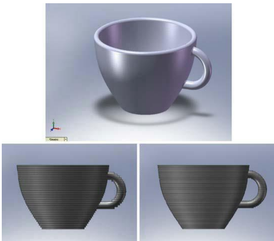
Рисунок 1.1 – Изображение САД-модели чашки и дополнительные изображения, показывающие, как воспроизводится ее форма набором слоев различной толщины
