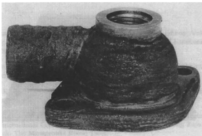
Рисунок 3.31 – Корпус термостата, полученный технологией 3D сварки
