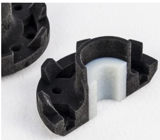
Рисунок 3.12 – Деталь, полученная процессом «PolyJet» с использованием двух материалов
