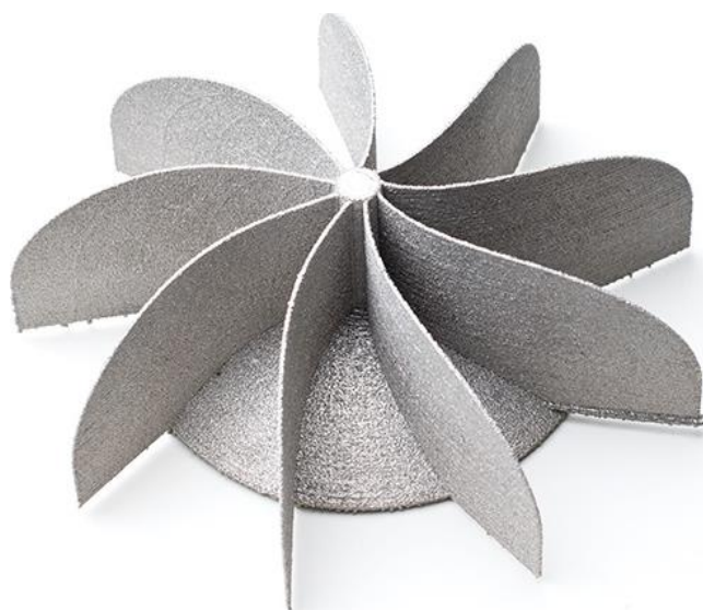
Рисунок 3.48 – Металлическая деталь, полученная электронно-лучевой плавкой
