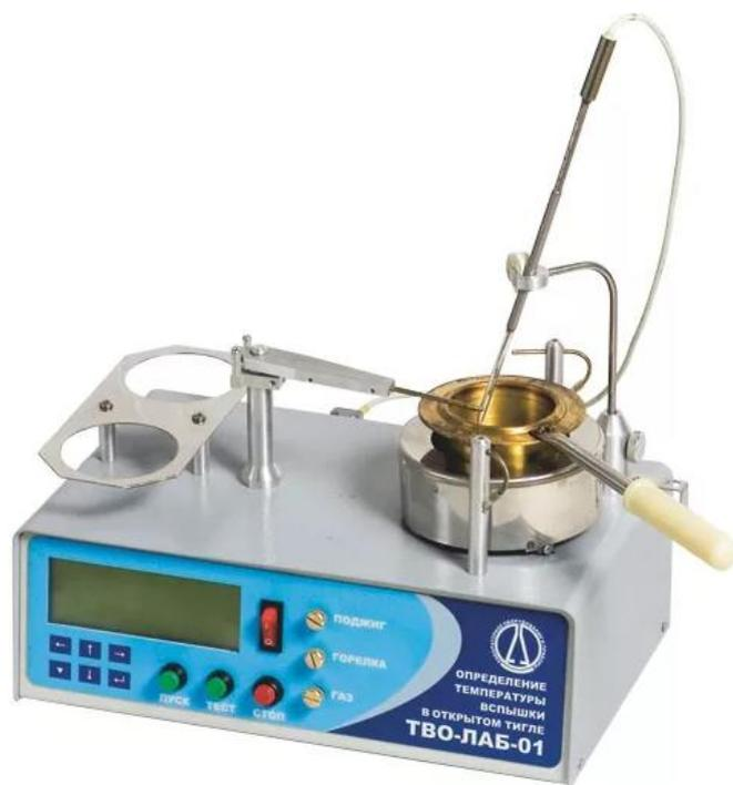
Рисунок 28б - Аппарат для определения температуры вспышки и воспламенения нефтепродуктов в открытом тигле
