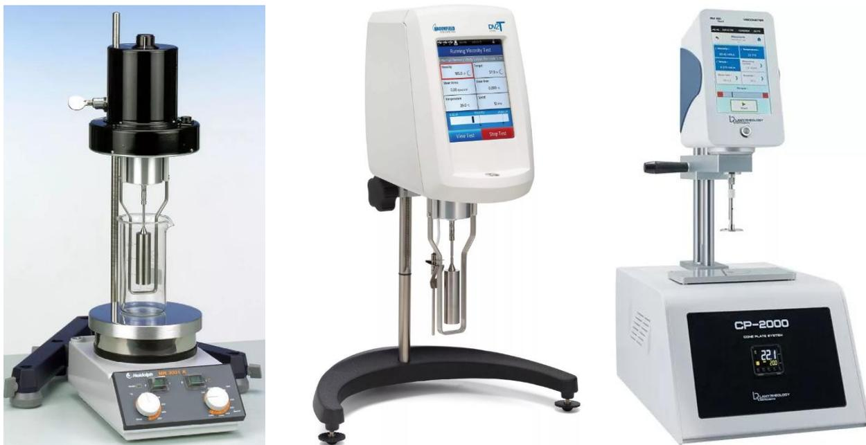
Рисунок 12 – Ротационные вискозиметры
