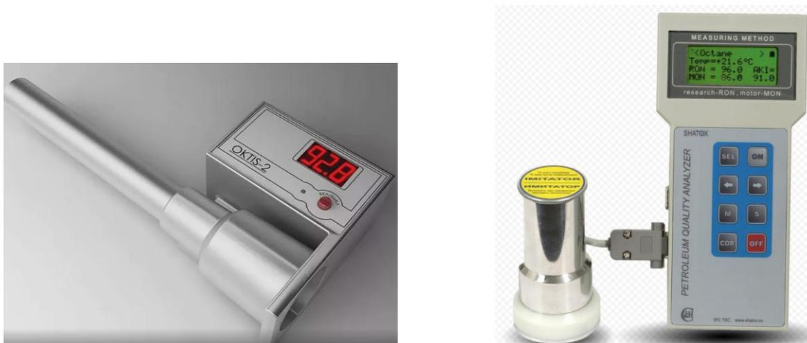
Рисунок 14 – Приборы для измерения октанового числа (цифровые)
