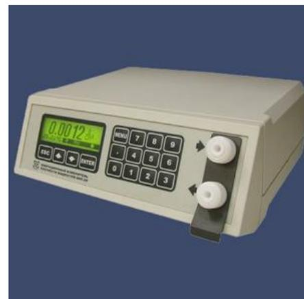
Рисунок 7 – Плотномер фирмы Термекс-II [13]
