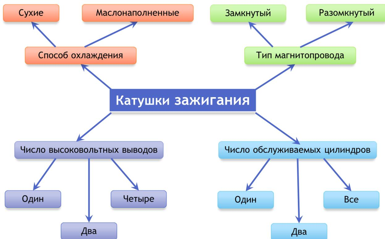
Рисунок 4.1 – Классификация катушек зажигания
