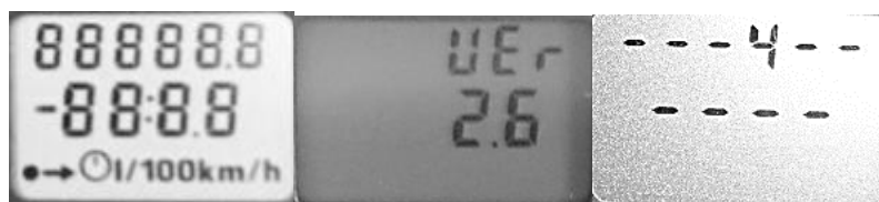
Рисунок 5.3 – Режимы самодиагностики комбинации приборов (в центре – версия прошивки, справа – коды ошибок)
