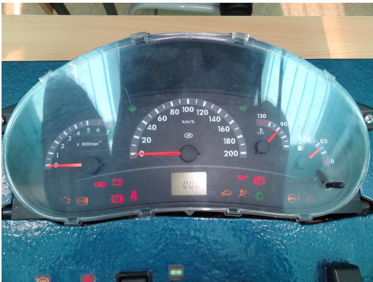
Рисунок 5.16 – Проверка комбинации приборов методом секвенции
