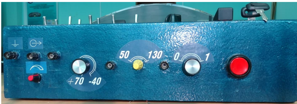
Рисунок 5.17 – Органы управления указателями уровня топлива, температуры охлаждающей жидкости и температурой окружающей среды
