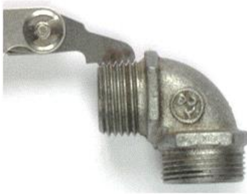
Рисунок 13 – Измерение шага резьбы резьбомером
