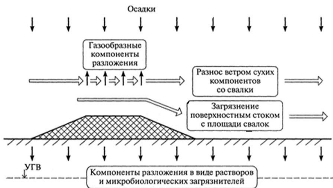
Рисунок 54 – Схема загрязнения окружающей среды свалками
