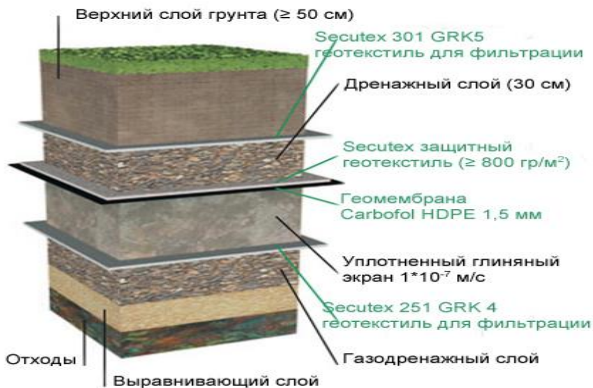
Рисунок 72 – Конструкция защитного экрана
