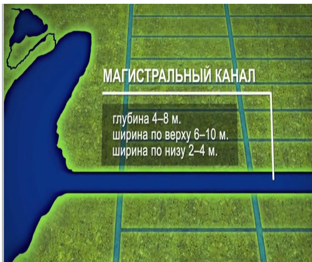
Рисунок 9 – Магистральный канал фрезерных полей
