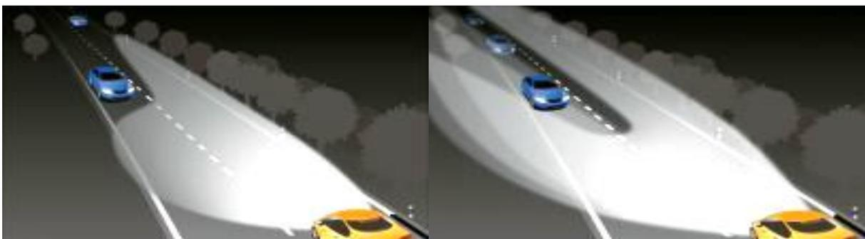
Рисунок 4.19 – Работа адаптивного освещения при встречном разъезде
