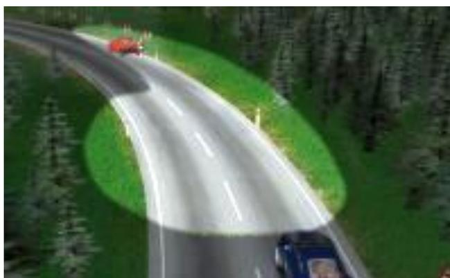
Рисунок 4.20 – Работа адаптивного освещения при прохождении поворота
