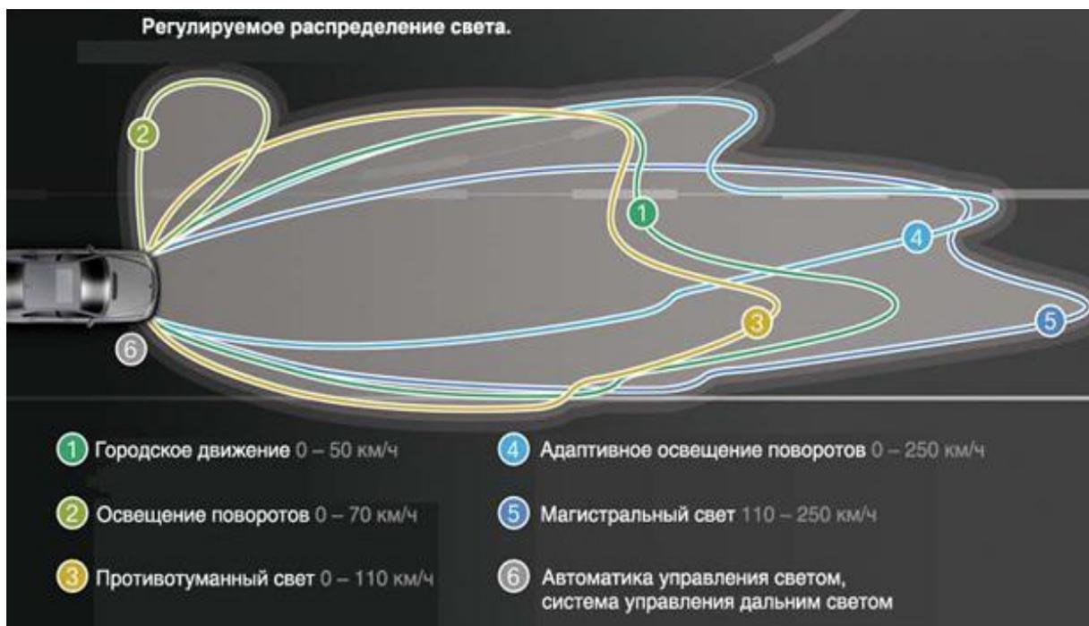
Рисунок 4.16 – Различные режимы адаптивного освещения
