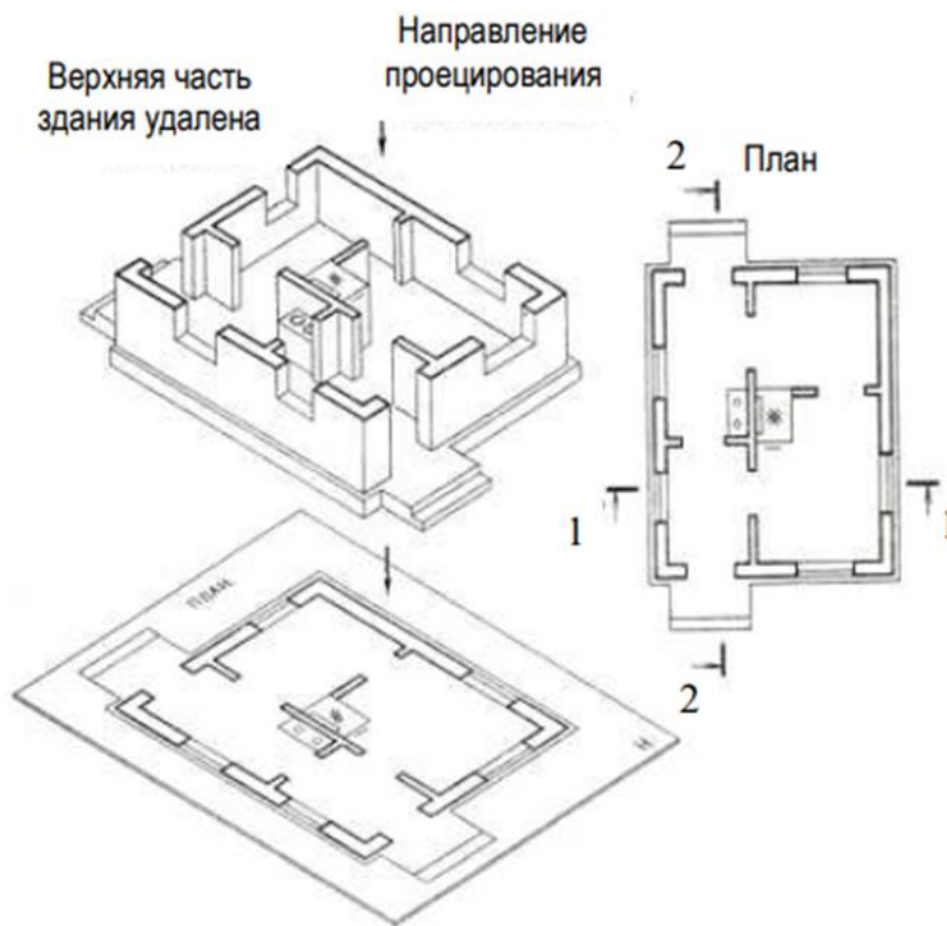
Рисунок 3.1 – Пример формирования плана этажа
