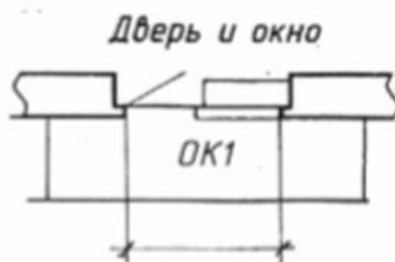
Рисунок 3.6 – Пример обозначения заполнения оконного (дверного) проема
