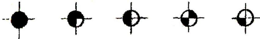
Рисунок 2.5 – Изображение условных обозначений отверстий
