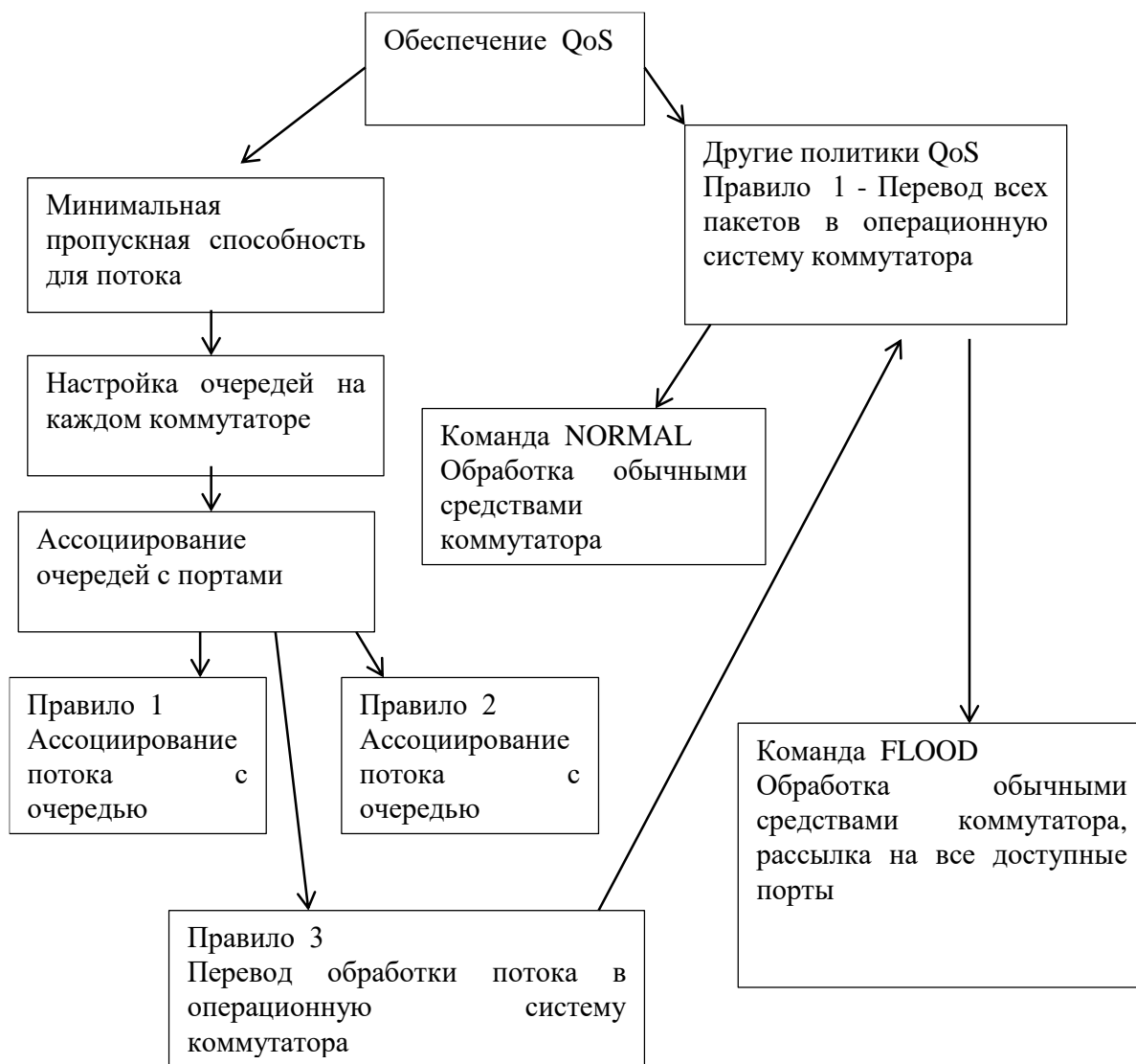
Рисунок 6 – Схема обеспечения QoS в OpenFlow коммутаторе
