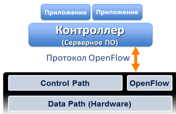
Рисунок 4 – Схема работы протокола OpenFlow
