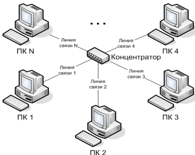
Рисунок 7.1 – Структурная схема одноранговой сети
