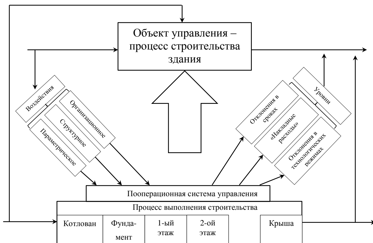
Рисунок 5 – Схема управления качеством строительства
