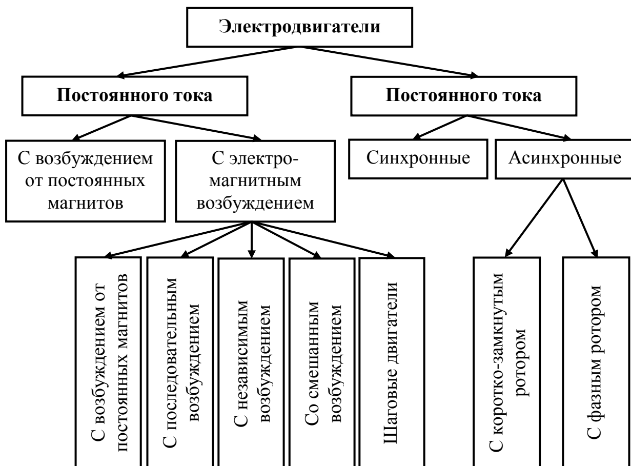
Рисунок 2.14 – Электродвигатели, используемые в приводах промышленных роботов
