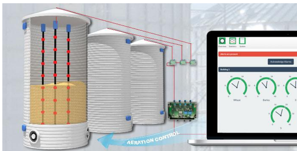
Рисунок 2.18 – Система дистанционного контроля температуры зерна в силосах элеватора (ДКТЭ)
