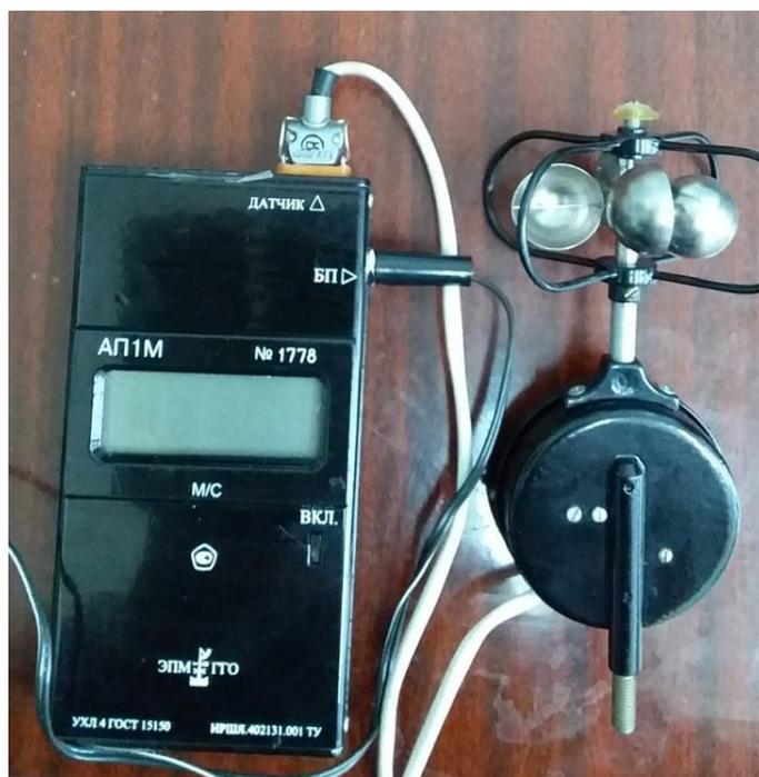
Рисунок -3 Анемометр чашечный электронный
