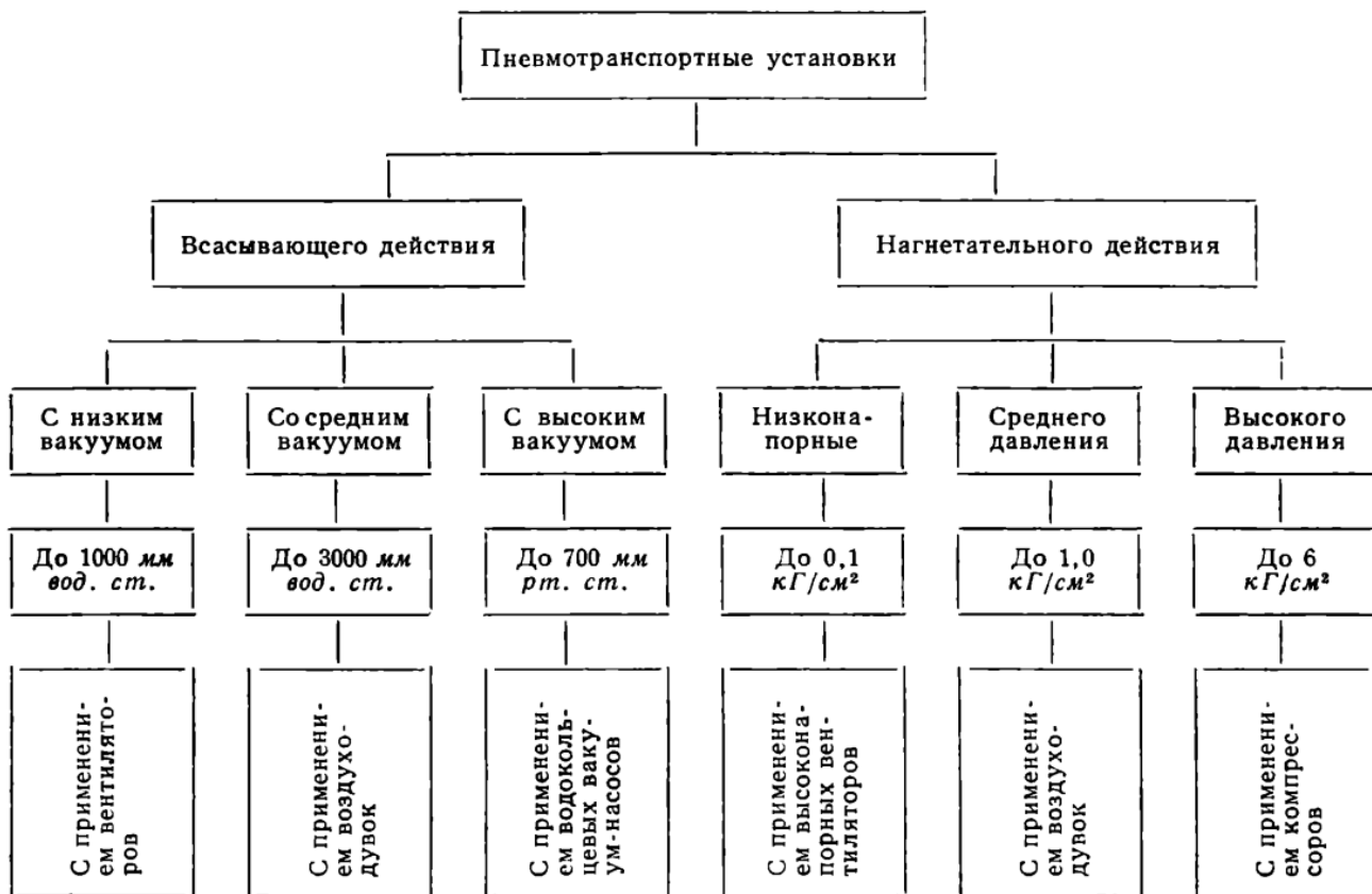
Рисунок 1.1 – Классификация пневмотранспортных установок, перемещающих материал в потоке воздуха
