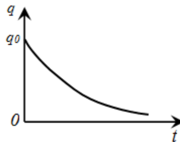
Рисунок 4 – Кривая изменения заряда на обкладках конденсатора при разряде конденсатора
