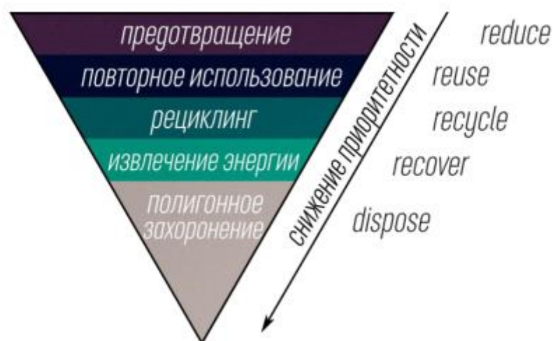
Рисунок 2.1 – Схематическое представление иерархии методов обращения с отходами
