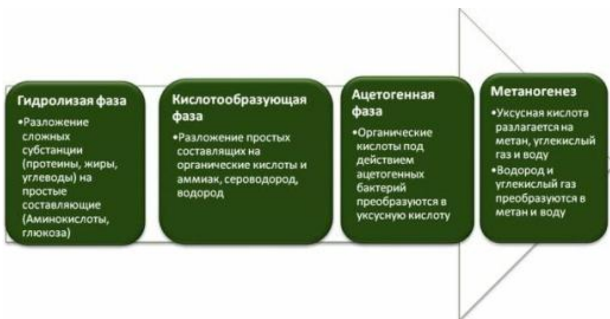
Рисунок 3.1. – Схема процесса образования биогаза
