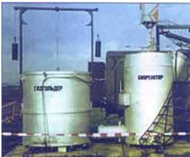
Рисунок 3.5 – Индивидуальная биогазовая установка для крестьянского хозяйства ИБГУ-1
