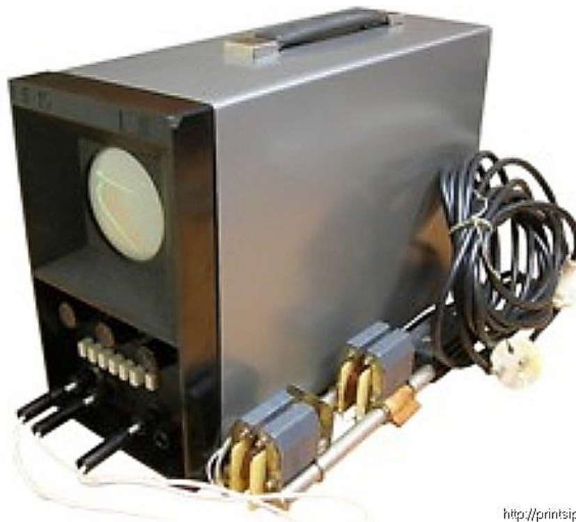
Рисунок Ж.23 - Прибор для проверки обмоток электрических машин
