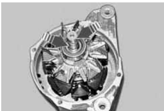
Рисунок Ж.13 – Осмотр контактных колец
