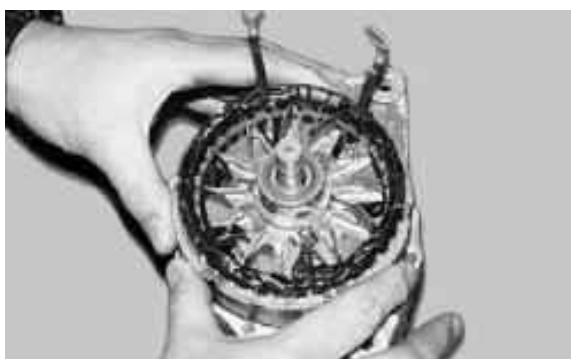
Рисунок Ж.10 – Снятие статора
