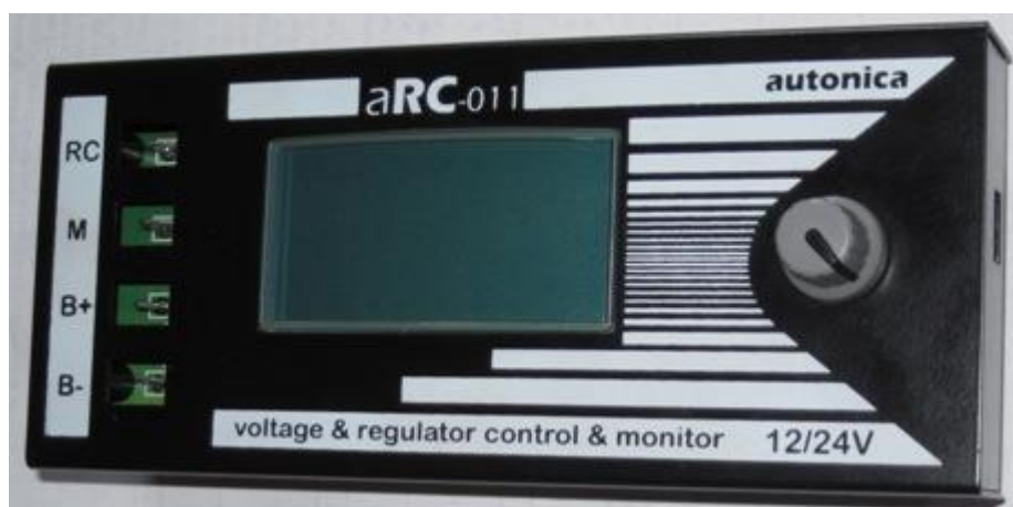
Рисунок Ж.21 – Приставка управления регуляторами напряжения генераторов
