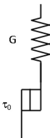
Рисунок 1.9 – Структурно-механическая модель упруго-пластического тела
