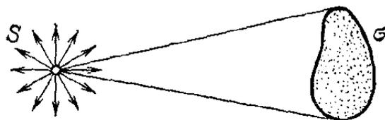
Рисунок 4.1 - Поток световой энергии, излучаемой источником S [9]
