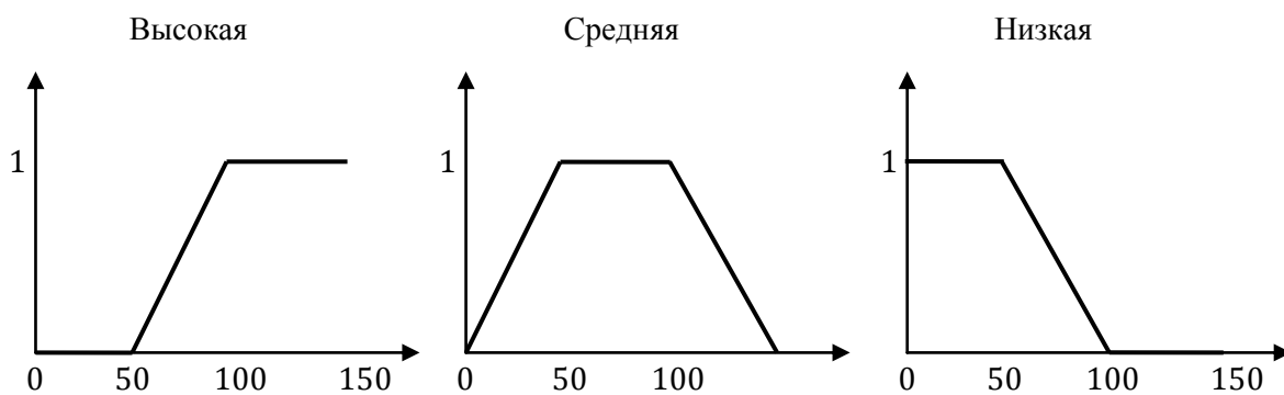
Рисунок 25 – Графики функций принадлежности термов лингвистической переменной «Температура»
