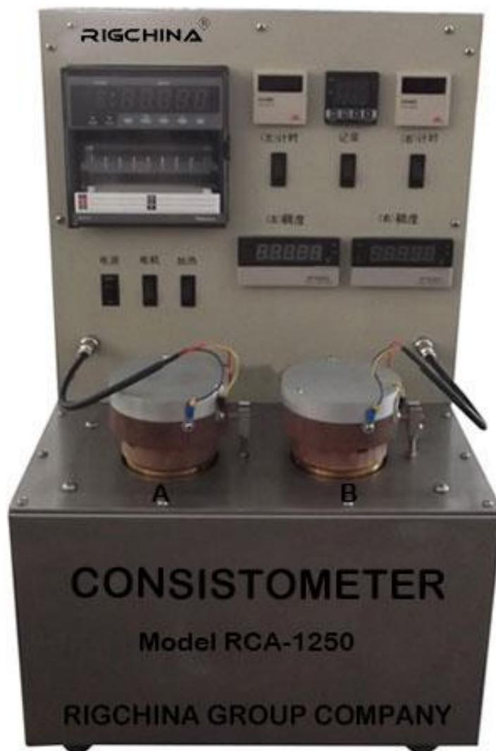
Рисунок 2.5 – Консистометр RCA-1250
