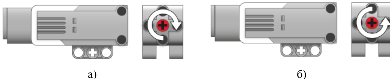
Рисунок 3.4 – Направление движение в зависимости от выбранной мощности: а – положительное значение мощности; б – отрицательное значение мощности
