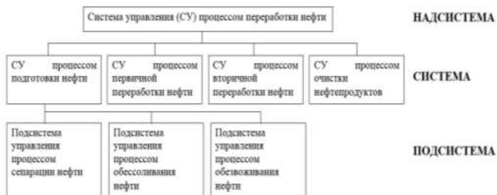
Рисунок 4 – Иерархия систем управления процессом переработки нефти
