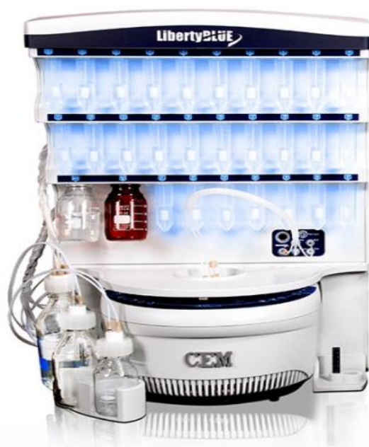
Рисунок 4.7 – Жидкофазный синтезатор CEM на основе растворимых полимеров.
