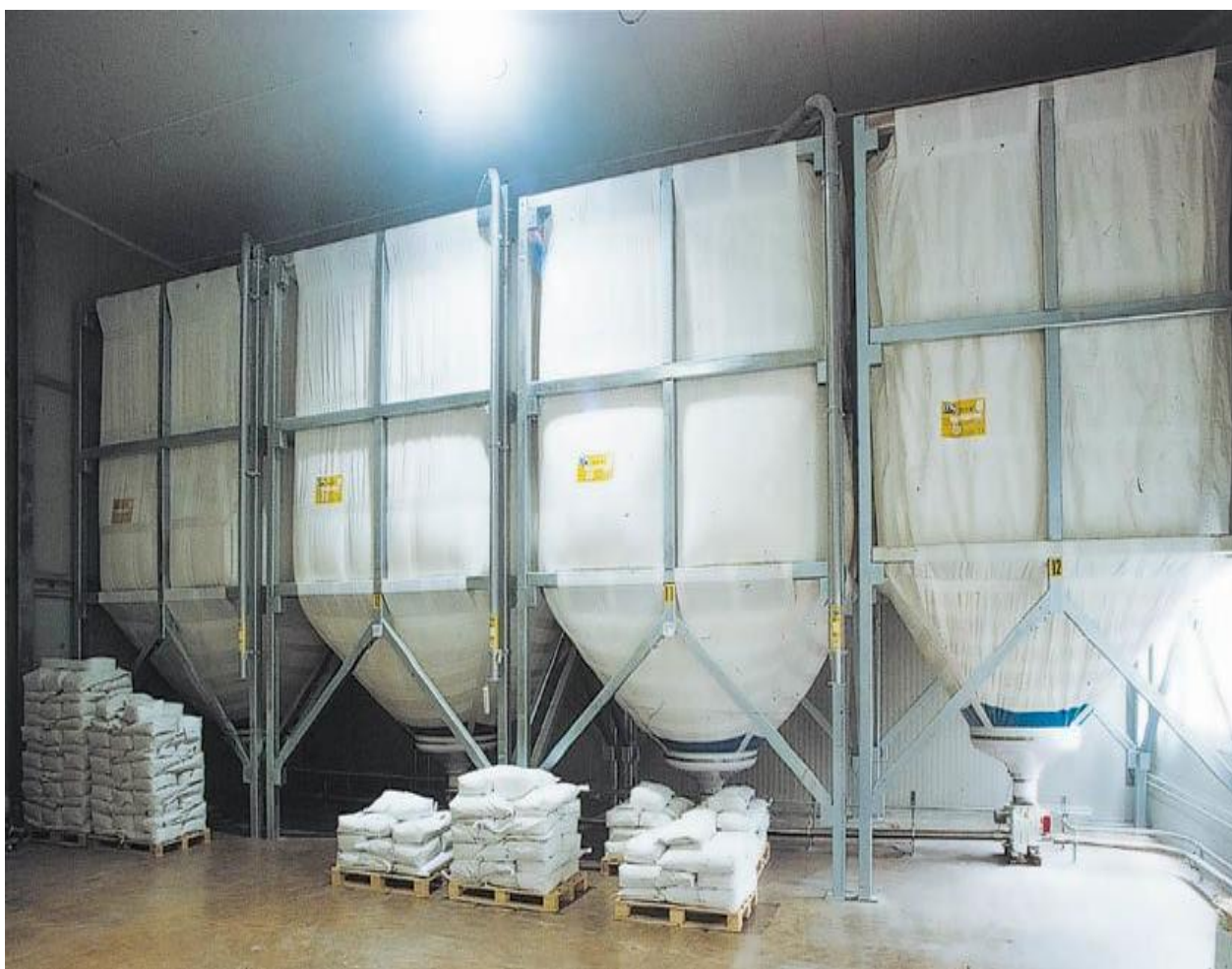
Рисунок 2.6 – Бестарное хранение муки внутри производственного корпуса
