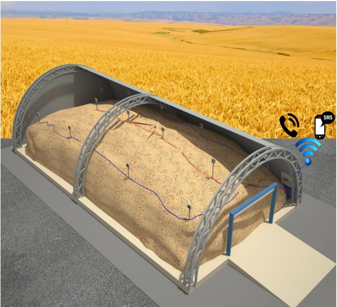
Рисунок 1.3 – Схема системы контроля температуры зерна в складе напольного хранения с помощью термоштанг
