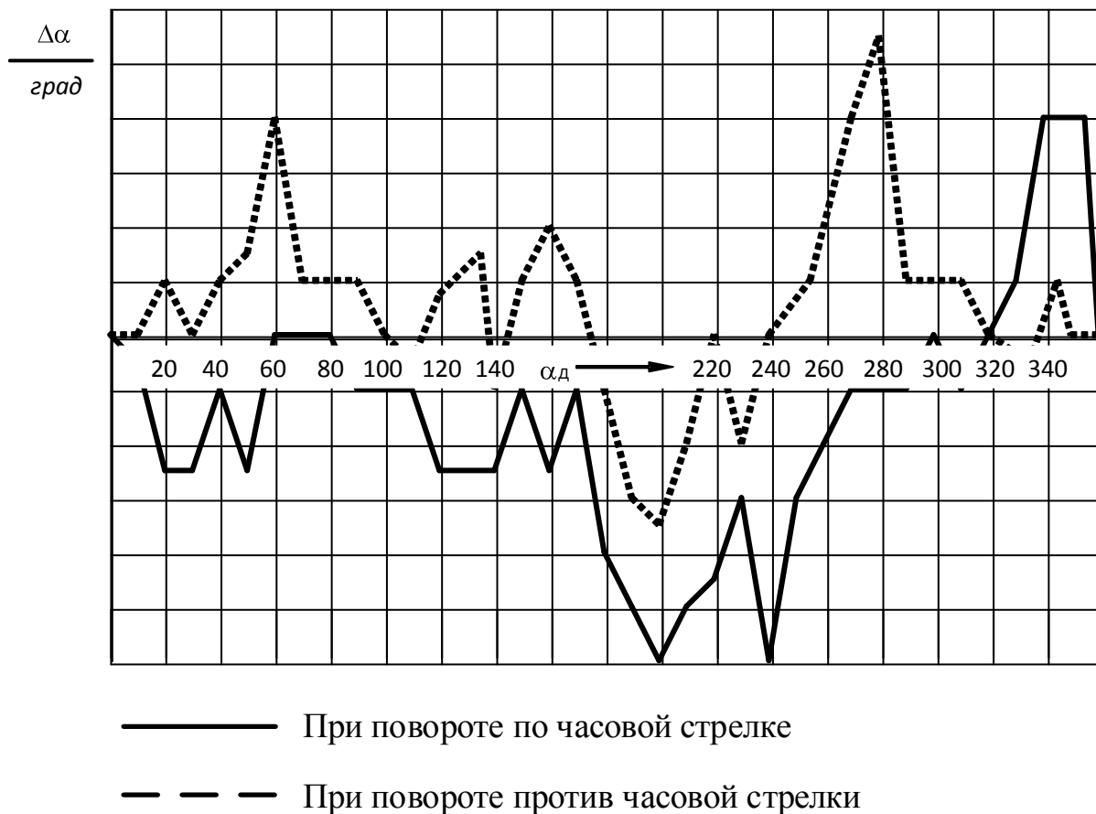
Рисунок 6.10 – Кривая ошибок сельсина-приемника
