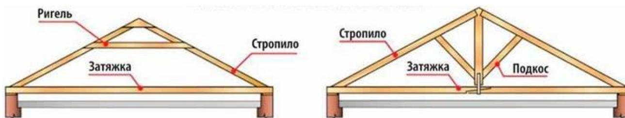
Рисунок 5.2 – Крыши с висячими стропильными системами для пролета 9 и 12 метров
