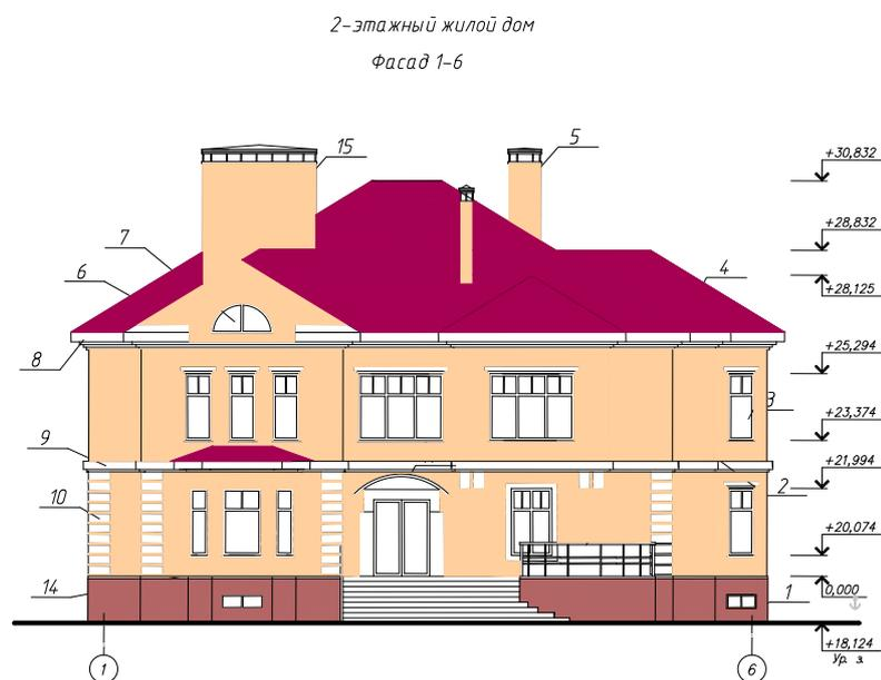
1 – цоколь; 2 – стена наружная; 3 – окно; 4 – скатная крыша; 5 – вентиляционный канал; 6 – фронтон; 7 – слуховое окно; 8 – венчающий карниз; 9 – фасадный этажный пояс; 10 – пилястра; 11 – корырек входа; 12 – перила ограждения; 13 – терраса; 14 – эркер; 15 – дымоход.
