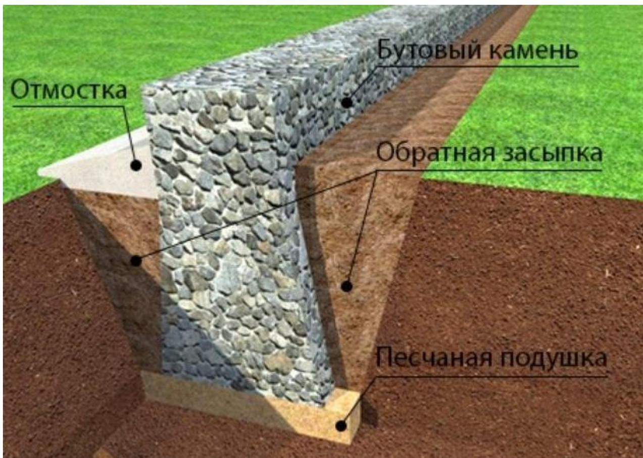
Рисунок 2.6 – Фундамент ленточный монолитный, бутобетонный, общий вид
