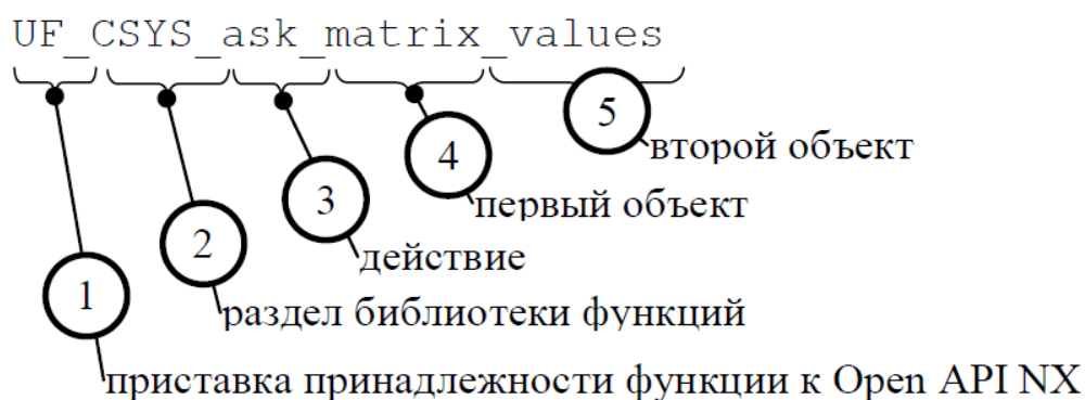
Рисунок 1.12 – Иллюстрация правил составления имен функций Open API NX
